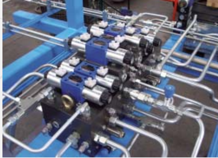
Hydraulic unit with one block and hoses Impianto idraulico con massello monoblocco e tuberia rigida.
